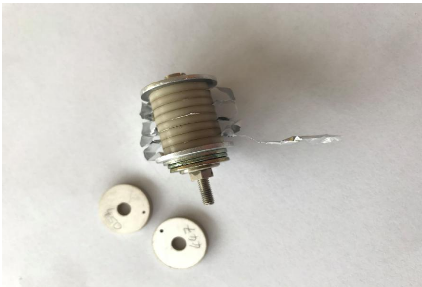
Obrázek 7) Původní vytvořený seismograf z piezokeramiky
