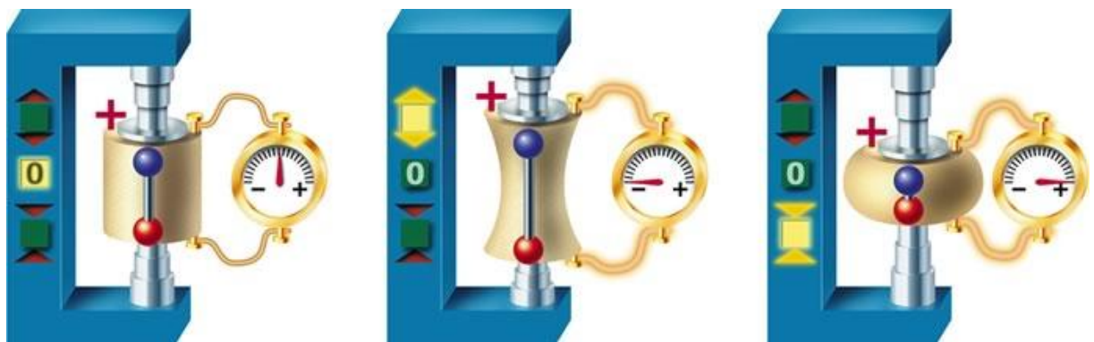
Obrázek 4) Ukázka fungování piezokeramiky při klidu, stlačení a roztáhnutí
