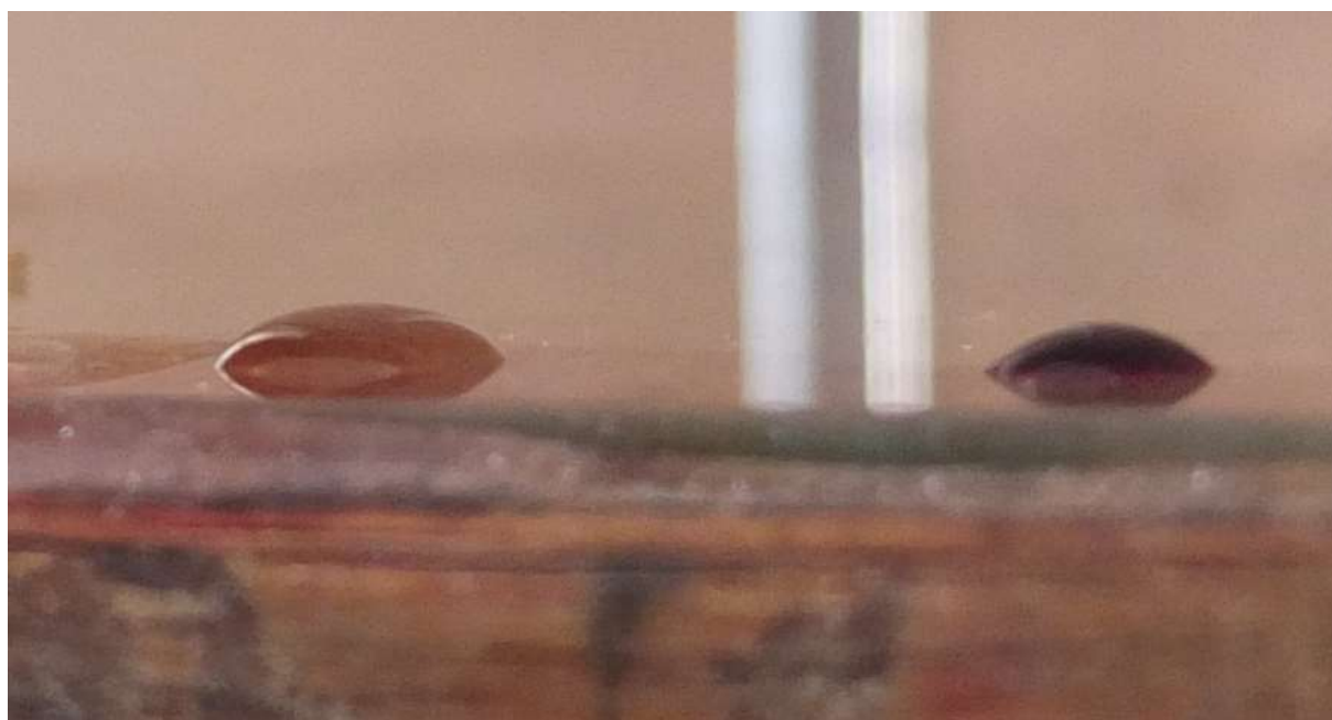
Obrázek 6 – kapy roztoků na skle pro určení kontaktního úhlu
